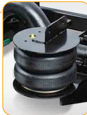
에어백 한쪽이 기울지 않고 균형있게 에어가 충전된 모습
